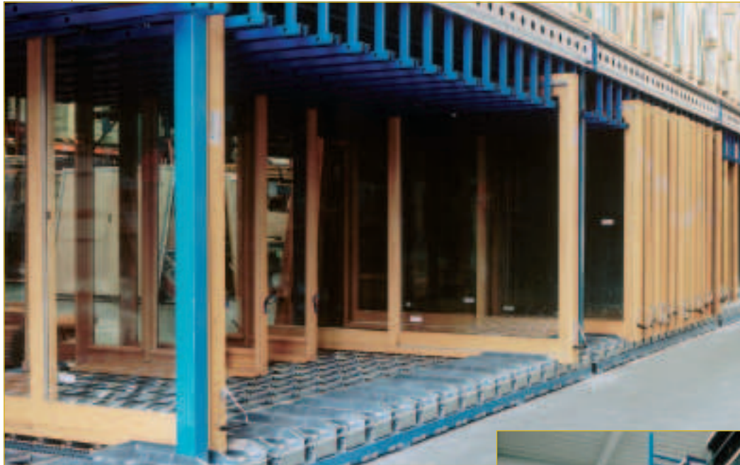
Stockage dynamique à rouleaux pour portes-fenêtre sous plate-forme PROPLUS LP.
