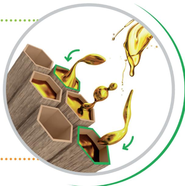
Grâce à sa structure micro-alvéolée, le Fibercan+ encapsule les liquides pour les séparer de l'absorbant réutilisable à l'aide d'un système de tamisage.
