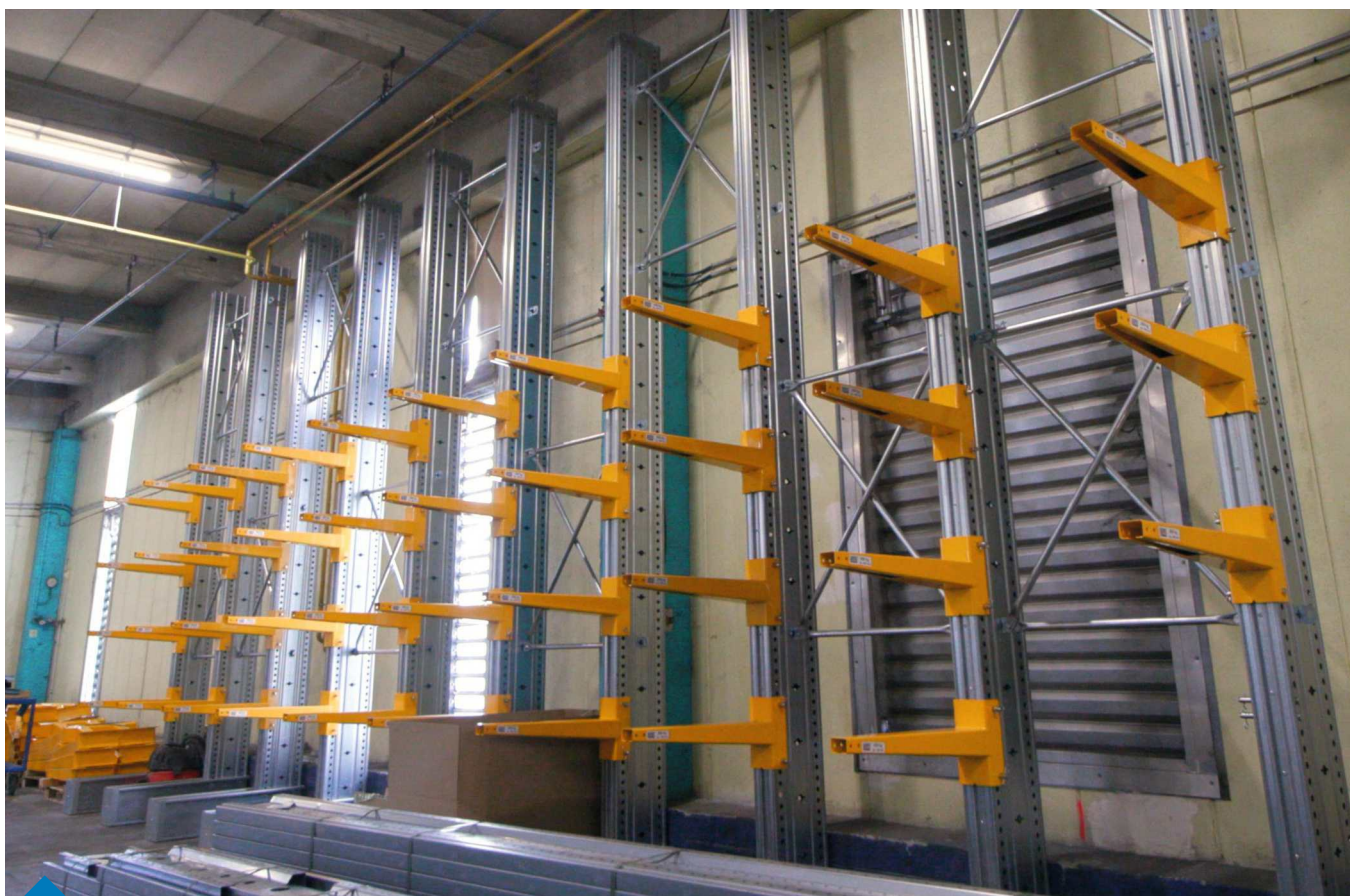
Installation de Cantipro 3
