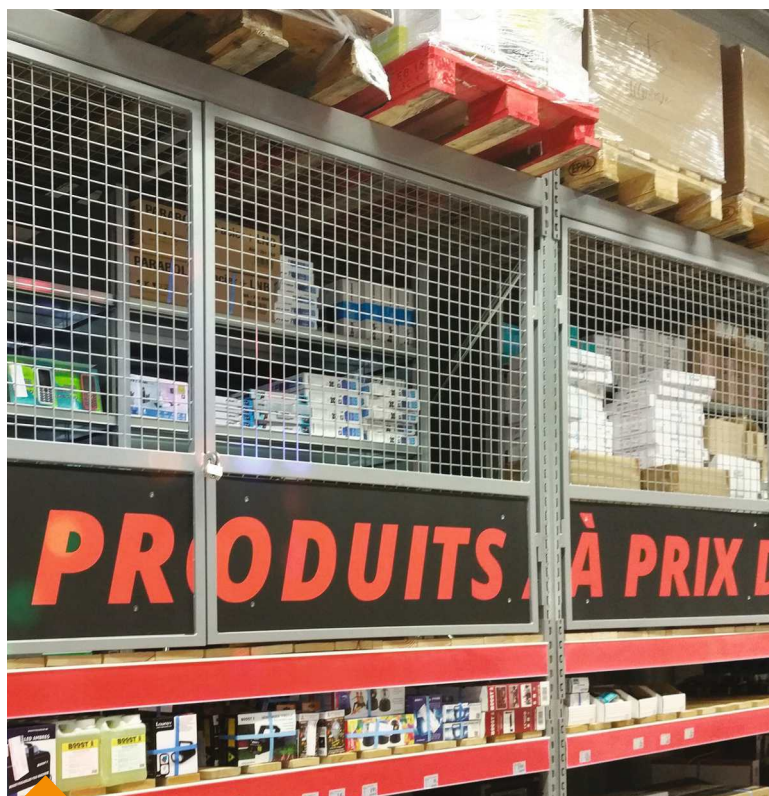
Sécurisation de la zone de stockage de produits en partie haute d'un rayonnage de magasin avec bandeau publicitaire sur les portes et zone de prélèvement en partie basse.
