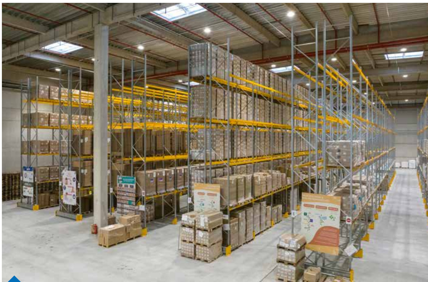
Cellule de 3 000 m2 de rayonnages Propal 3, 4 niveaux + sol, dernier niveau de dépose à 8770 mm.
