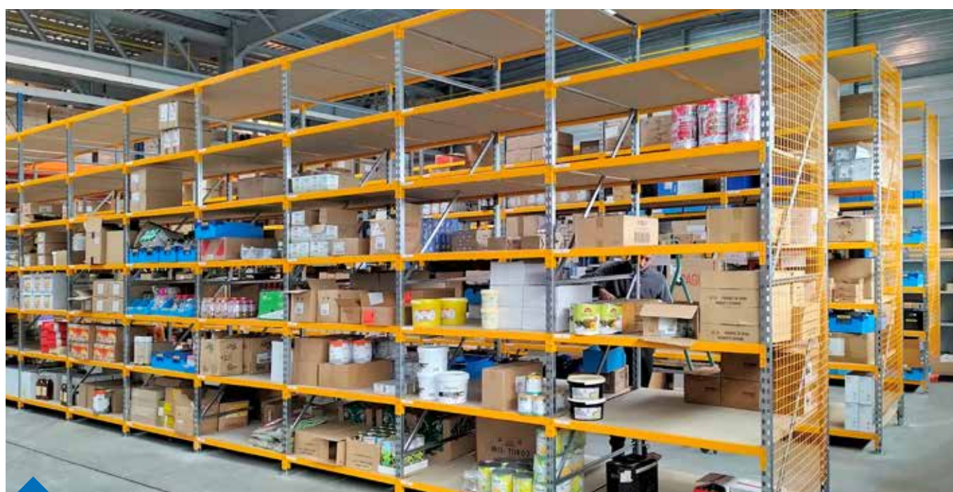
Picking de denrées alimentaires dans la réserve d'un centre hospitalier. Prorack+ équipé de côtés grillagés pour éviter la chute des produits.
