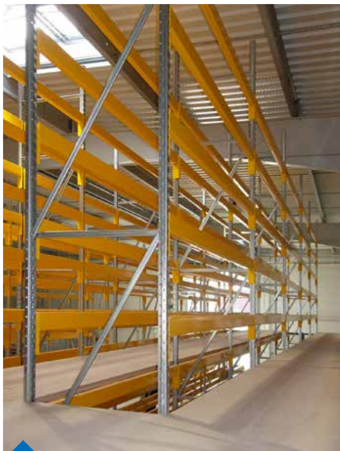
Plateforme avec allées de circulation fixées sur les échelles Prorack+ de hauteur 5 400 mm.
