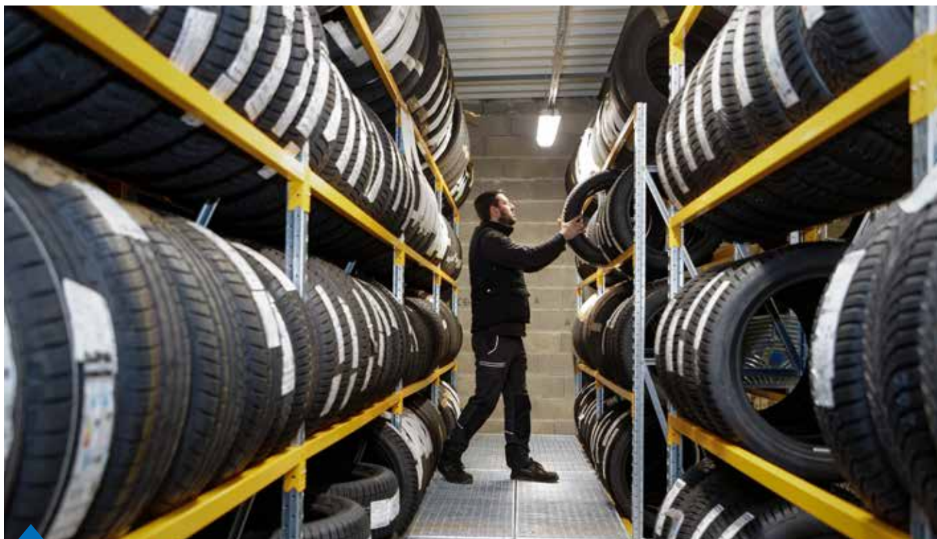
Plateforme avec allée de circulation en caillebotis sur des rayonnages Prorack+ pour le stockage de pneus en grande hauteur.
