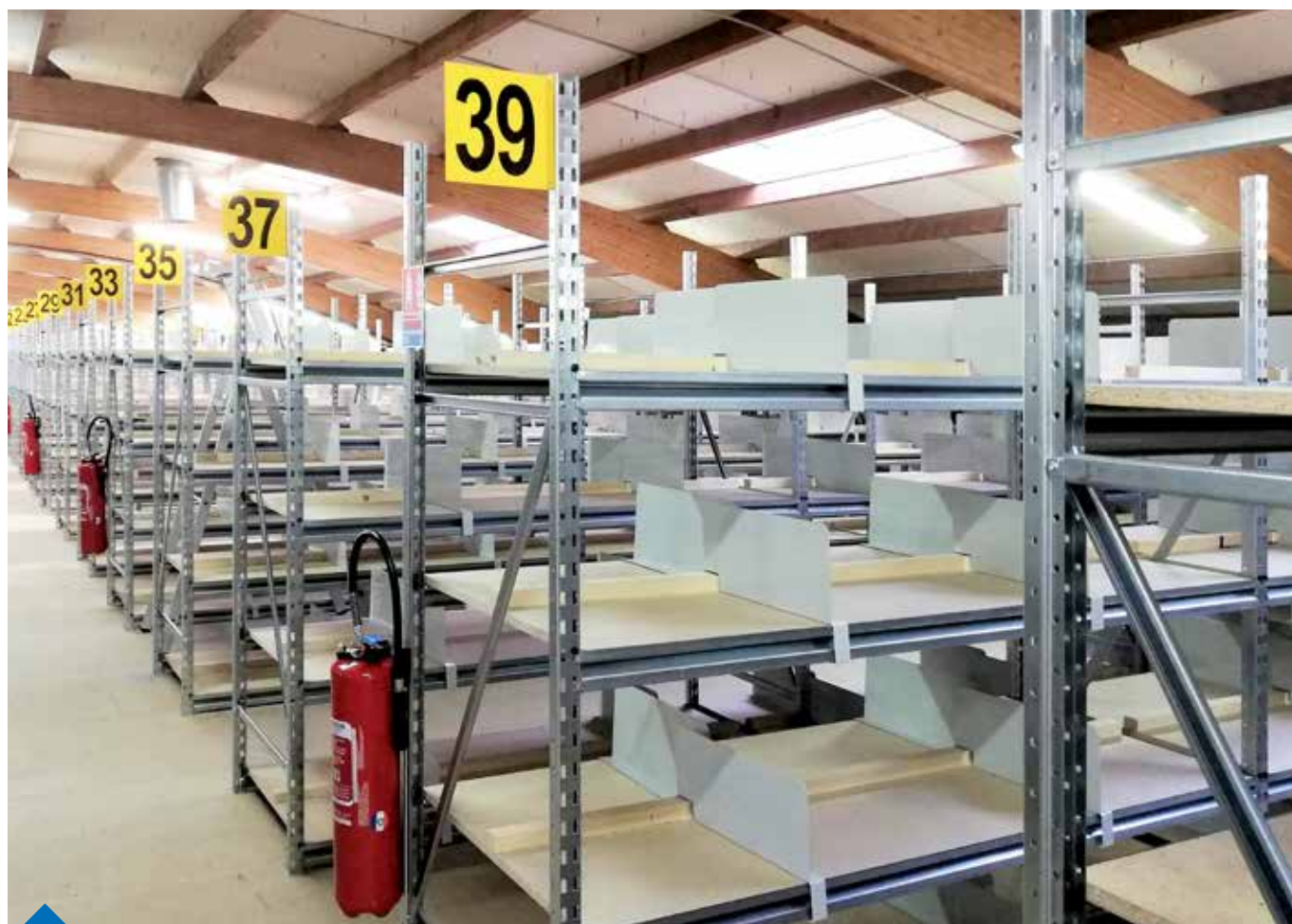
Zone de picking en rayonnages Prorack+ sur mezzanine. Les niveaux sont divisés par des séparateurs dont la position s'ajuste par coulissement en fonction de la quantité de références d'un même produit.
