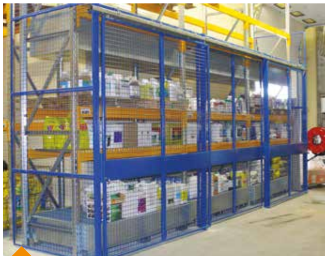
Cloison avec portes coulissantes pour limiter l'accès à des produits chimiques stockés dans des baies de rayonnage lourd, sur bacs de rétention.
