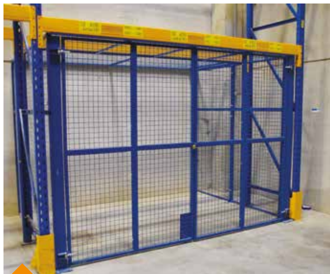
Box de stockage avec toit grillagé, intégré dans une baie de rayonnage à palette.
