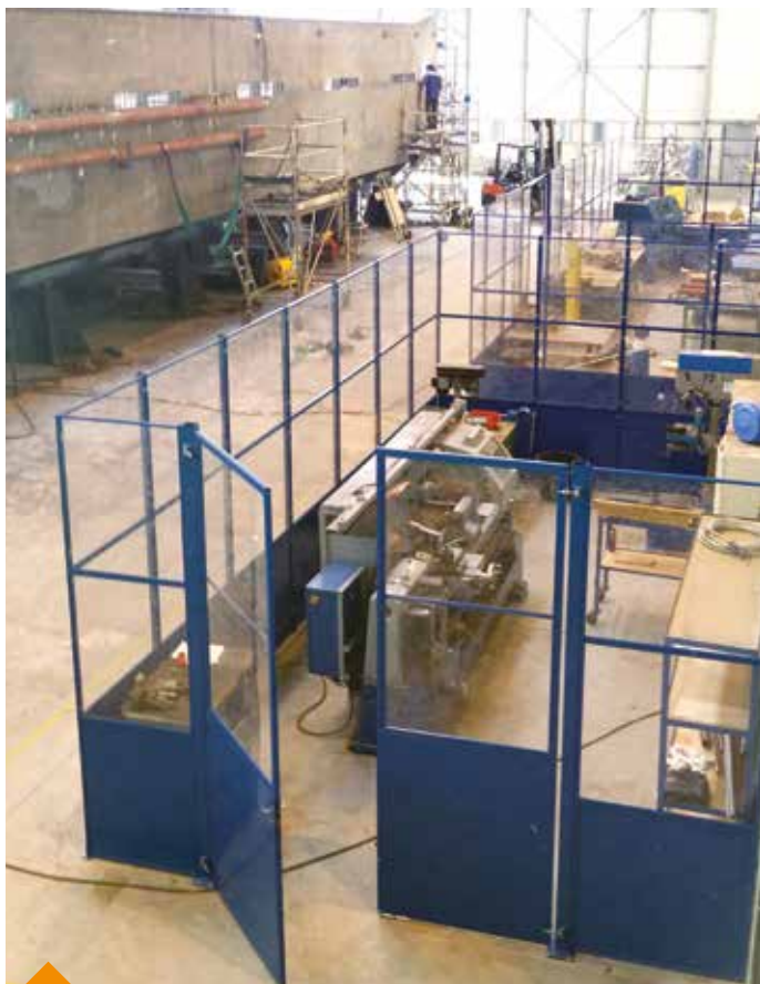
Intégration d'une cloison 5S pour créer un espace de travail sécurisé et protégé des courants d'air.
