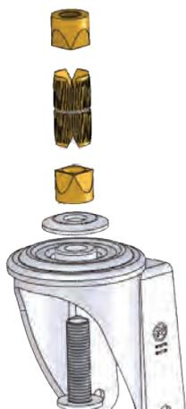
Il est conseillé de serrer le produit avec une tige à expansion aux structures tubulaires avec des couples de serrage opportuns. Des couples de serrage insuffisants peuvent en effet compromettre la stabilité et/ou la capacité de charge totale du produit.
