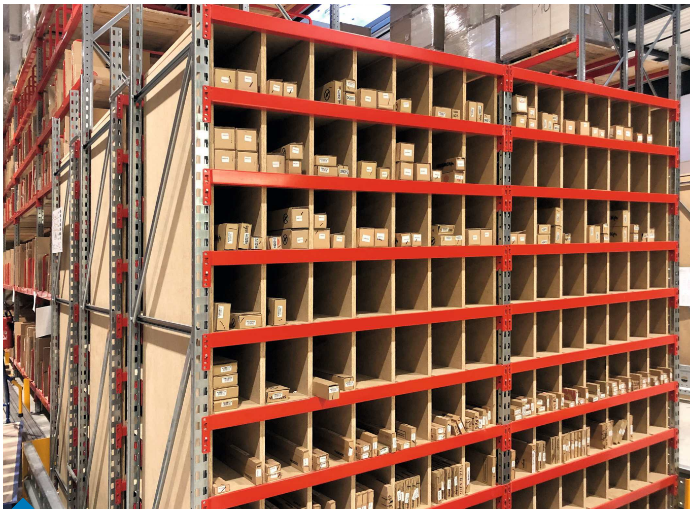
Stockage de charges longues à l'horizontale. Casiers en bois sur mesure pour loger des plinthes.
